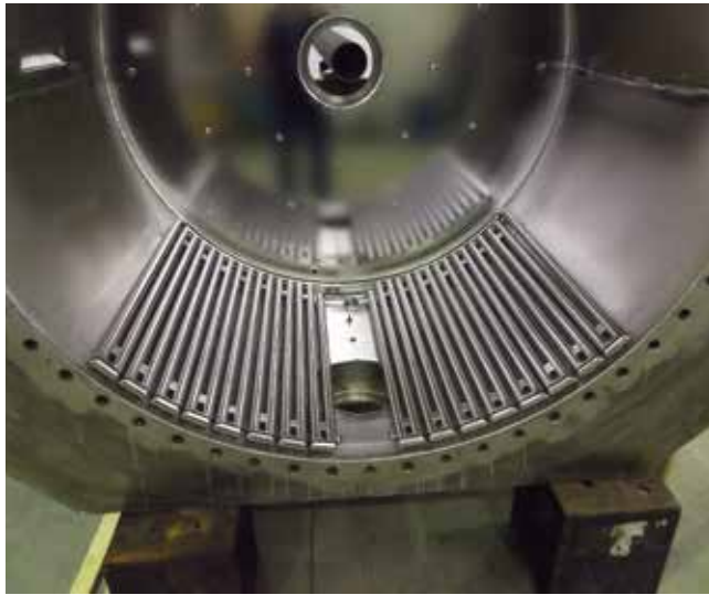
Außentrommel mit Wärmetauscher – elektrochemisch poliert External drum with heat exchanger – electrochemically polished
