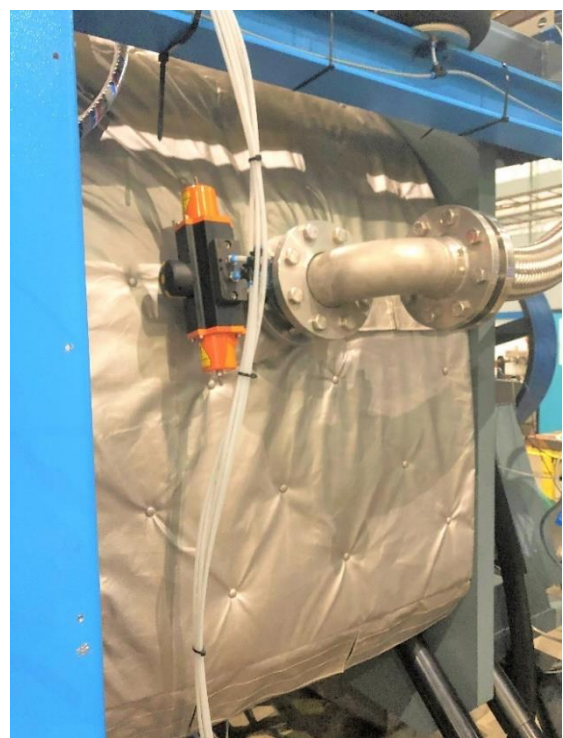
Außentrommel mit 25 mm Isolierung
